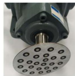
图 7 安装于轴端的靶标盘
