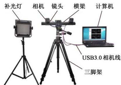
图10 测量系统硬件
